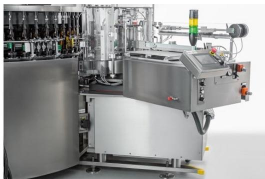
Equipada com estrutura e componentes de aço inoxidável, a rotuladora EvoDECO Cold Glue tem design higiênico, sendo totalmente lavável.
