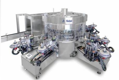
*Die schnelle Rundläufer-Etikettiermaschine Sidel SL90 kann schnell zwischen Haft- und Kaltleimetikettierung wechseln*
