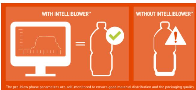
*En contrôlant les paramètres de la phase de présoufflage au lieu de se concentrer uniquement sur la régulation de la chauffe, le système Intelliblower™ de Sidel a un plus grand impact sur l'uniformité de la production et la qualité de l'emballage.*
