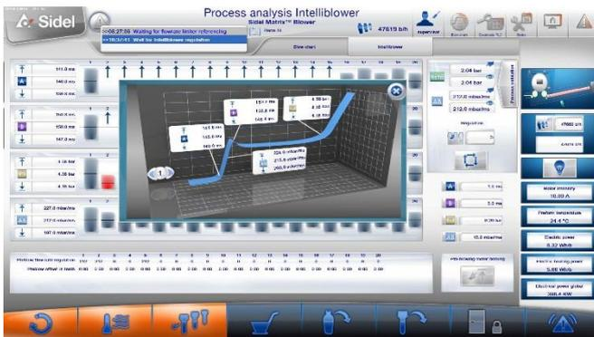
*Le système Intelliblower™ de Sidel supprime les écarts de répartition de la matière en analysant et en contrôlant la courbe de soufflage sur chaque bouteille PET.*
